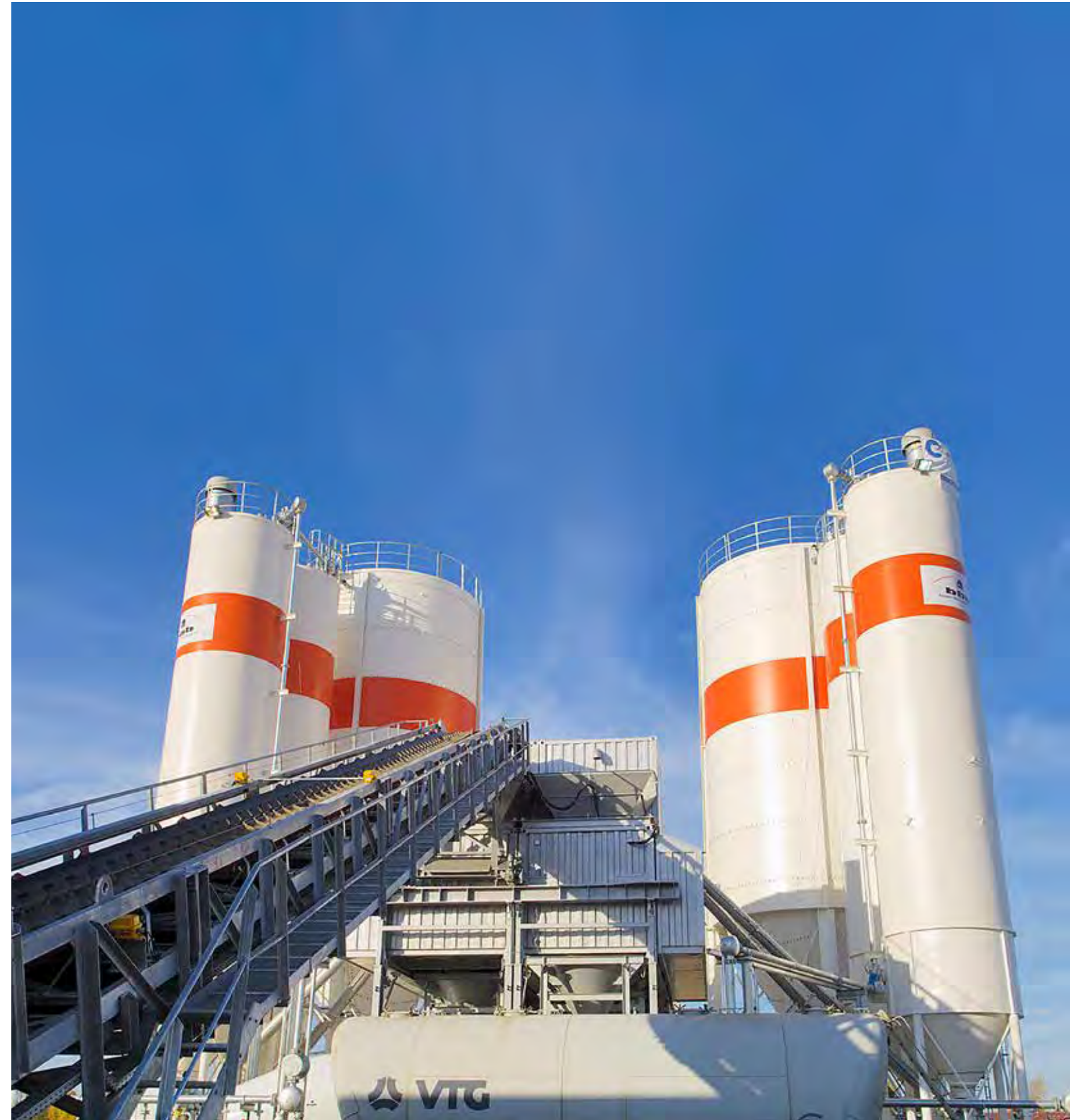
Wirtschaftlich umstritten, aber technisch eindrucksvoll: Die zentrale Betonmischanlage war die größte in Deutschland
